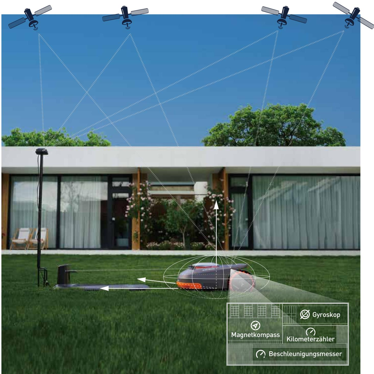
Mit dem Exact Fusion Locating System (EFLS) von Segway Navimow kann die virtuelle Begrenzung, basierend auf satellitengestützter Technologie mit einer Positionierungsgenauigkeit bis auf wenige Zentimeter genau angelegt werden, ohne dass ein Begrenzungskabel erforderlich ist.
